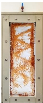
Obr. 15: Plastový deskový modul pro filtraci při tlaku 20 kPa opatřený A) (ML) 2 3L 0,21 membránou a B) MPU 0,67 membránou
