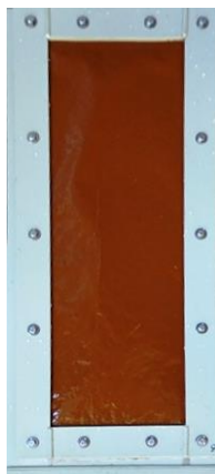
Obr. 15: Plastový deskový modul pro filtraci při tlaku 20 kPa opatřený A) (ML) 2 3L 0,21 membránou a B) MPU 0,67 membránou
