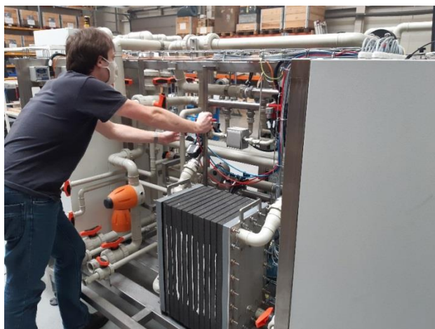
Obr. 7: Sestava membránové jednotky včetně upraveného poloprovozního membránového modulu.
