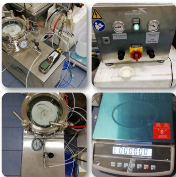
Obr. 4.3 - Membránová jednotka Novoflow CRD-01–152 a váhy se sběrem dat pro měření množství permeátu.
